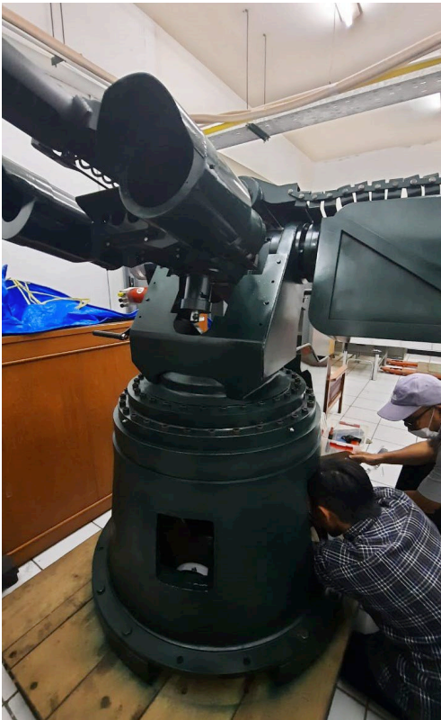
Fisik prototipe sistem Turret hasil manufaktur yang telah mencapai tahap integrasi subsistem pada Maret 2022.
